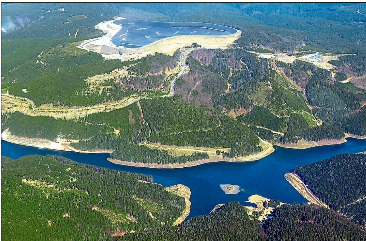
So liegt ein Pumpspeicherkraftwerk mit Ober- und Unterbecken in der Landschaft, hier das größte Deutschlands in Goldisthal (Landkreis Sonneberg, Thüringen) noch während der Bauphase vor zehn Jahren. Sämtliche Technik mit Rohren, Turbinen und Maschinen liegt unterirdisch. – Unten: Wirtschaftsministerin Ilse Aigner. (Foto: Stefan Thomas/dpa)
